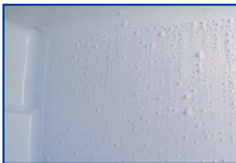
Slika 3a: Zid hladnjaka (oblast isparivača) sa injem
