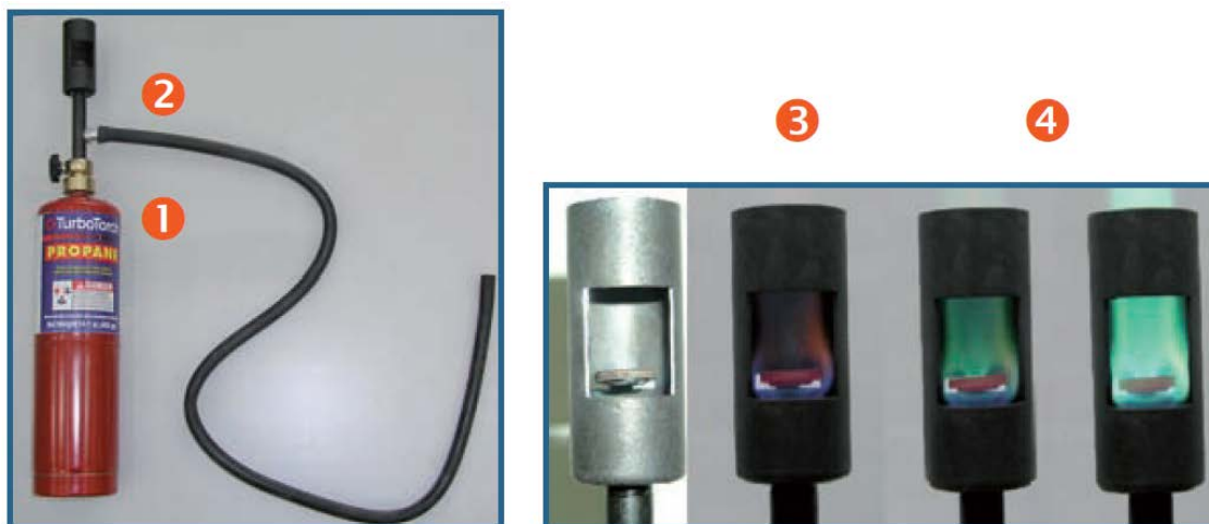
Slika 3: Halidni detektor curenja (zabranjena upotreba u EU)
