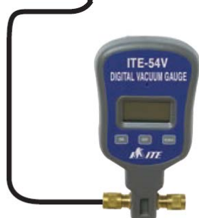
Slika 24: Vakuumiranje rashladnog sistema
