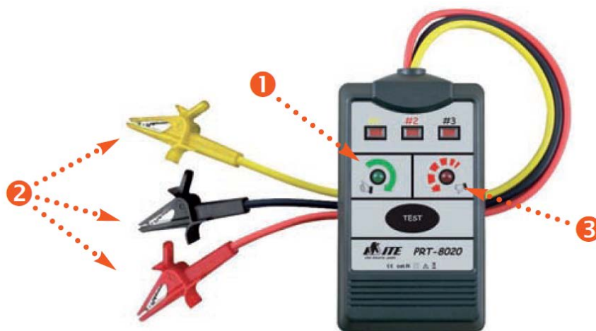
Slika 13: Kontrola smjera obrtnog polja (redosljed faza)
