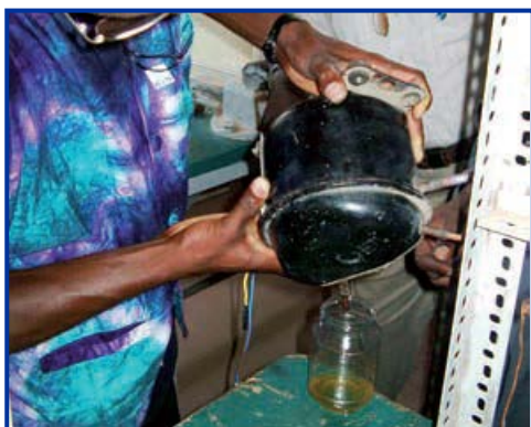
Slika 17: Uzimanje uzorka ulja iz hermetičkog kompresora
