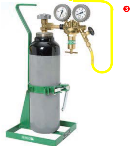
Slika 17: Povezivanje sistema za test curenja
