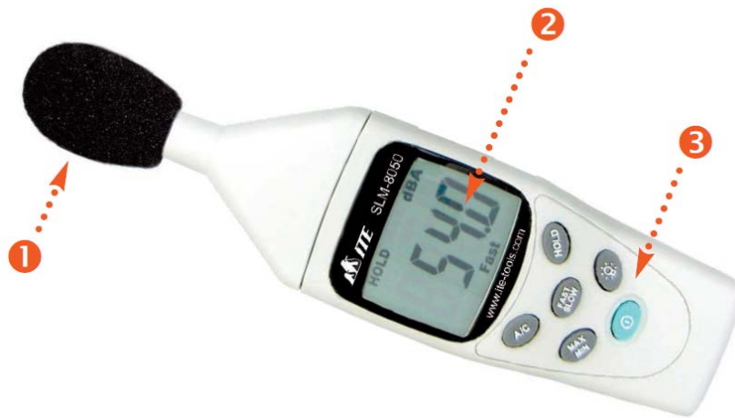
Slika 16: Mjerač nivoa buke
