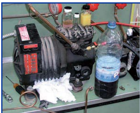
Slika 18: Uzimanje uzorka ulja iz poluhermetičkog kompresora
