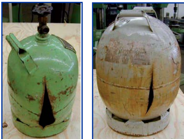
Slika 3: Primjeri cilindara koji su eksplodirali zbog prepunjavanja
