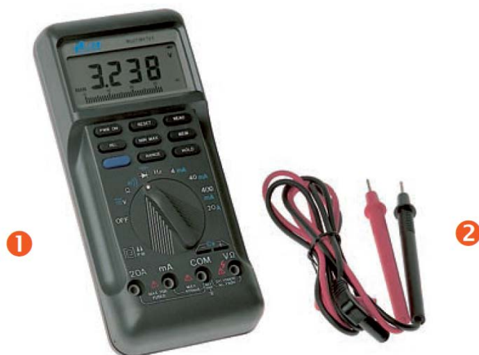
Slika 14: Digitalni multimeter sa automatskim izborom opsega
