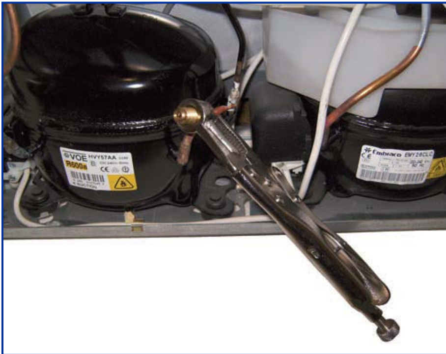
Slika 7: Postavljanje kliješta sa ubodnim priključkom
