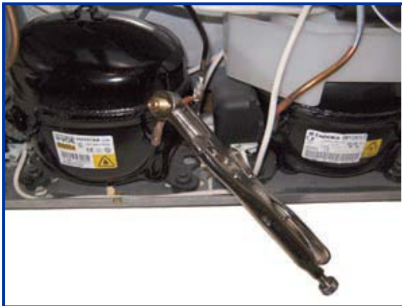
Slika 13: Povezivanje azota na servisnu cijev
