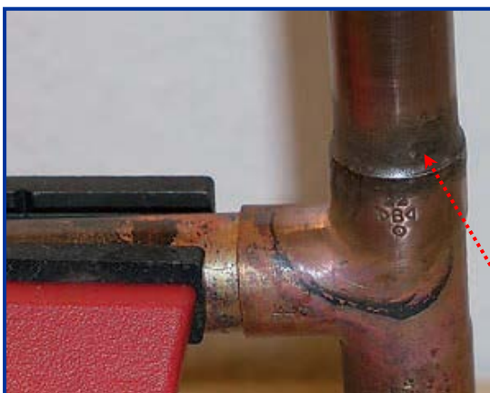
Slika 11: Izgled zalemljenog mjesta
