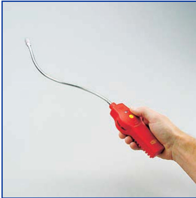
Slika 21: Završni test curenja pomoću elektronskog detektora curenja 2
